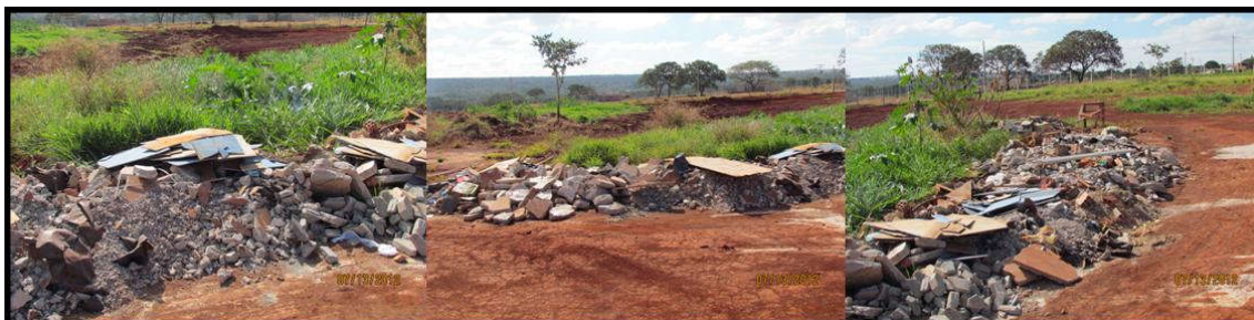
Figura 1 Resíduos de construção civil, que foram coletados para a fabricação dos agregados, na Unidade Flamboyant do Câmpus Jataí, em julho de 2012.
